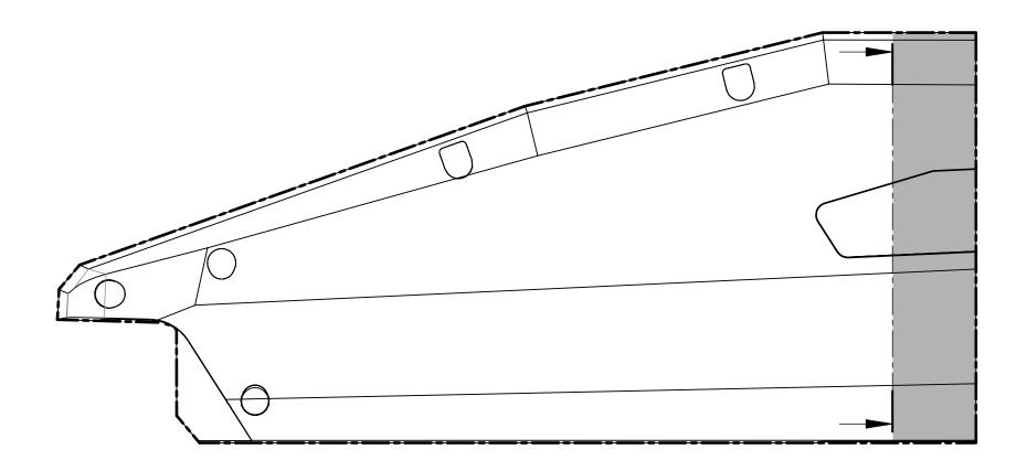
Bitte beide Konturen ausschneiden und an der Klebestelle mit Kleber zusammenfügen. Evt. wegen der Steifigkeit auf einen Karton aufkleben. Nun können Sie die Schablone in den Rahmen halten, um zu prüfen, ob die Ersatzbatterie in die Rahmengeometrie passt.
